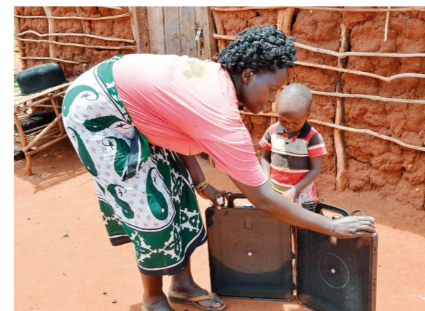
Solvatten är en kombinerad vattenrenare och vattenvärmare.
